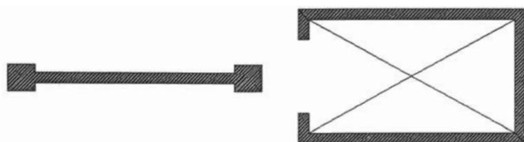
Secciones Eficientes para Muros de Cortante
