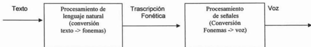
Fig. 1.1. Estructura básica de un sintetizador de voz
