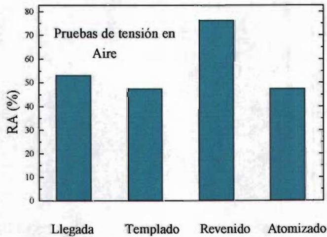
**Figura 3.14. Efecto del tratamiento térmico en la reducción de área para el acero X-70 en las pruebas de tensión en aire.**
