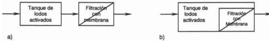
Figura 4.6 Tipos de bio-reactores de membrana, a) MBR externo y b) MBR interno.
