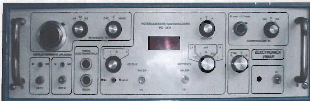
Figura 25. Potenciostato/ Galvanostato PG-2EV marca Electrónica Vimar.
