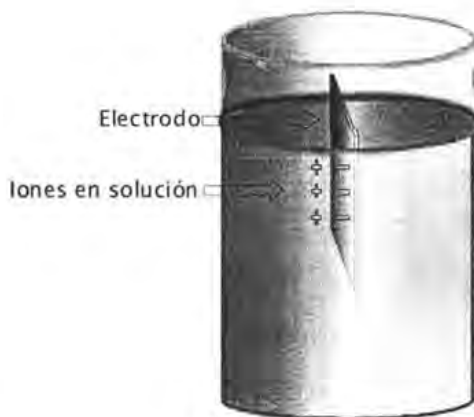
Figura 3.1. Un metal sumergido en un electrolito que contiene sus iones en solución.
