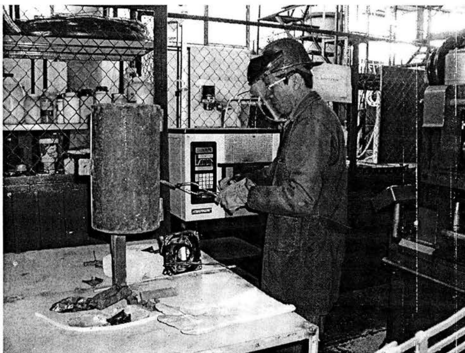
Fig.16 Panorámica de proceso de enfriamiento gradual controlado de piezas de acero 410
