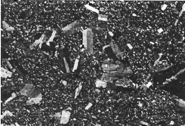
Figura 4.13. Fábrica porfídica relicta en metandesita. Luz polarizada, ancho de vista 5.5 mm.
