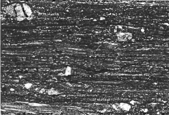
Figura 4.15. Fábrica milonítica en metadacita. Luz polarizada, ancho de vista 5.5 mm.
