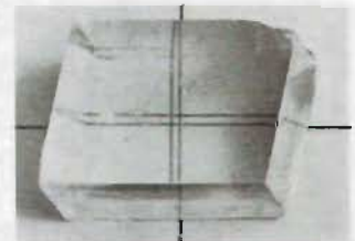
Cristal de calcita en el que se aprecia la doble refracción
