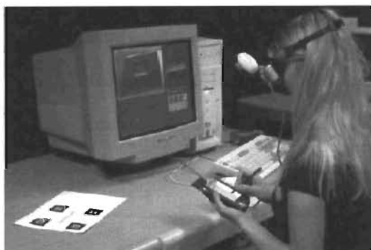
Figura 3.9 Prueba de uso de PocketHouseAR, la cámara esta montada sobre el HDM. En el monitor se observa lo que aparece en el HDM y en la PDA
