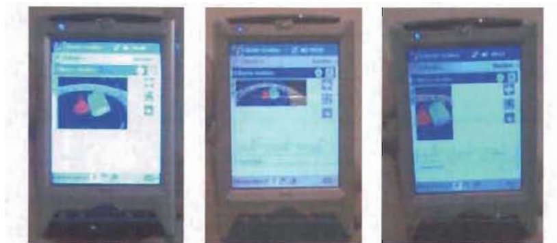
Figura 4.10 Imágenes de la aplicación visualizando el modelo de prueba con distintas dimensiones, de izquierda a derecha, 160x120, 160x60 y 80x120 píxeles, respectivamente.
