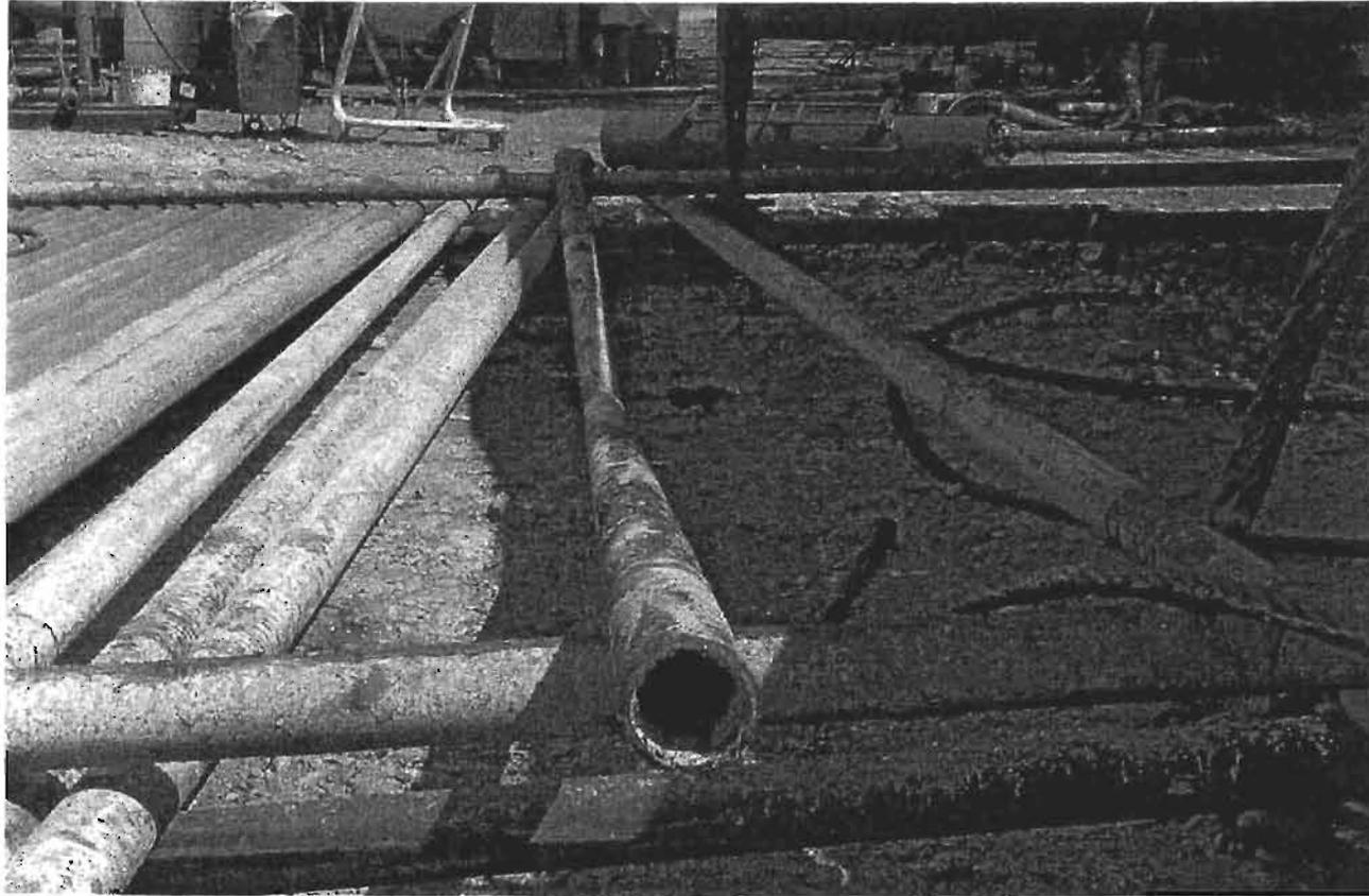
**Figura 10 Agrietamiento por corrosión debido a la presencia de agua y sulfuro de hidrógeno**
