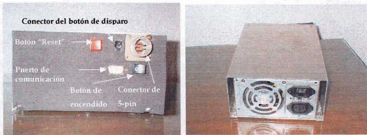
Foto 4 Parte frontal y trasera de la caja electrónica para la conversión analógica digital
