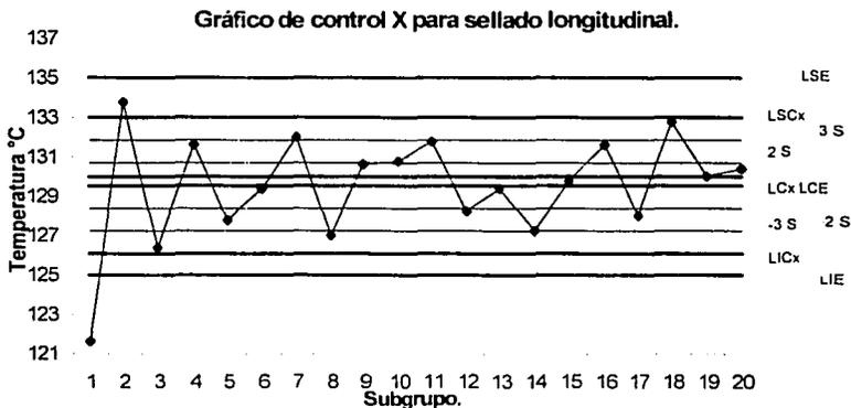
Figura 26. Gráfico de control de medias para el sellado longitudinal.
