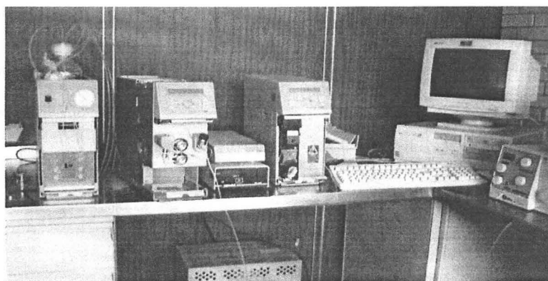
Figura 2.2. Cromatógrafo de líquidos de alta presión con detector de fluorescencia.
