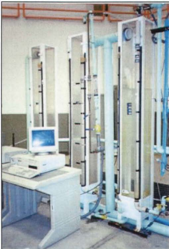
Lámina 5.8. Calibración volumétrica del rotámetro.
