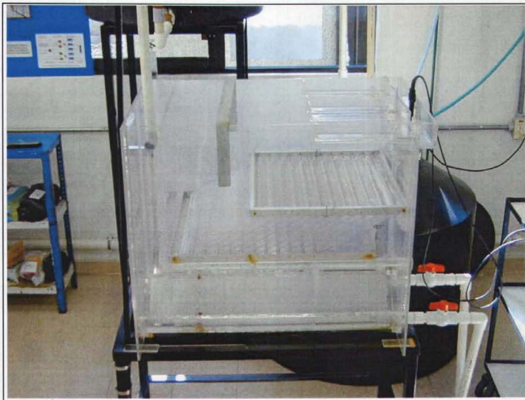
Lámina 5.1. Prototipo de sedimentador de alta tasa utilizado para las pruebas con trazadores.
