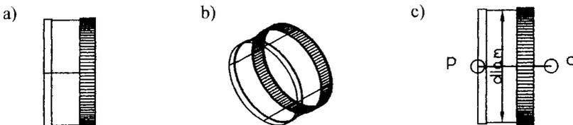
Figura III.2.12 Dibujo generado por la función *TapaRed*. a) vista superior b) vista isométrica c) coordenadas.
