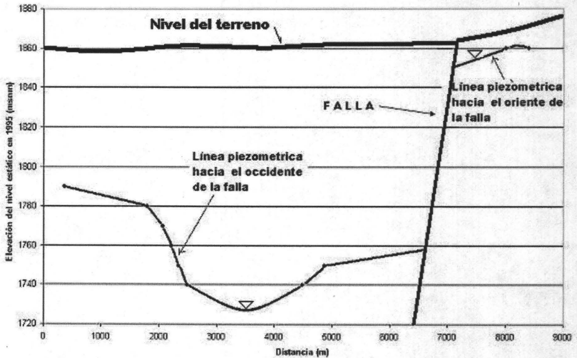
Figura 1.3 Sección trasversal piezométrica B-B'.
