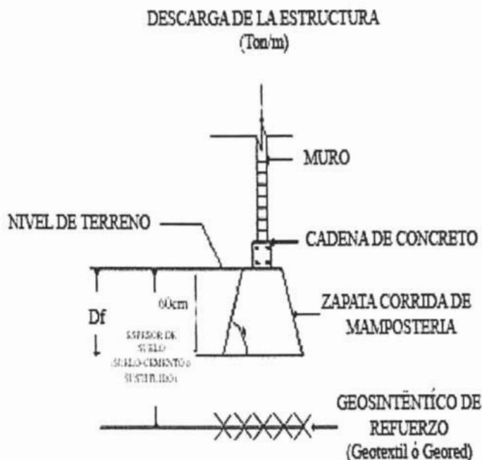
Figura VII.7 Esquema de una zapata corrida de muro
