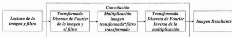
Fig. 3.10 Estructura general de un filtrado
