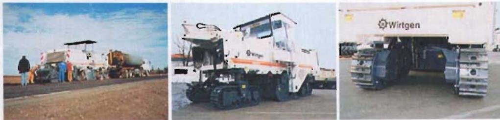
Fig 7.6 Equipos derivados de fresadoras de pavimentos montados sobre orugas
