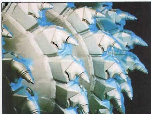
Fig 7.1 Picas o puntas de widia o tungsteno de rápido intercambio
