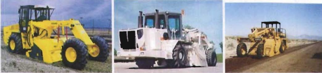
Fig 7.4 Equipos para el reciclado de pavimento (de izq a der. BomagMPH121, HammRaco 350 y Caterpillar RM350)
