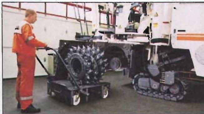
Fig 7.3 Reemplazo de rotor fresador
