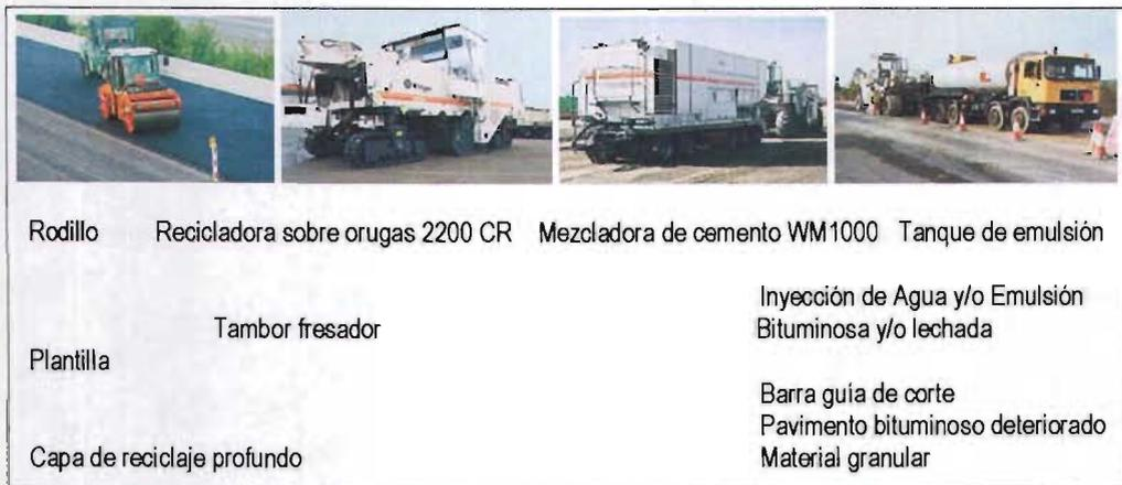
Fig 3.5 Tren típico de reciclaje con emulsión asfáltica utilizando máquina recicladora montada sobre orugas
