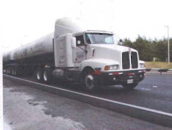
vehículos T3-S2 y T3-S2-R4. Ambos con eje delantero sencillo y traseros duales en tractocamión. El primero, sólo con ejes duales en semiremolque mientras que el segundo en semiremolque y remolque.
