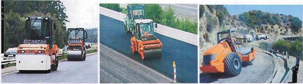
Fig 5.9 Compactadores de rodillo liso (de izq a der. Hamm HW90, HW130 y Modelo 3412)
