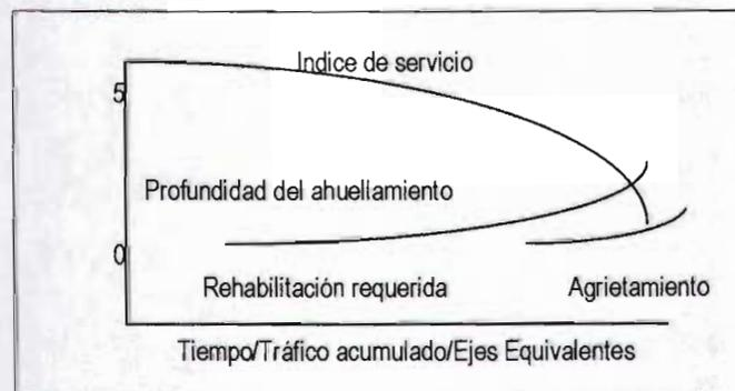
Fig 2.6 Indicadores del pavimento
