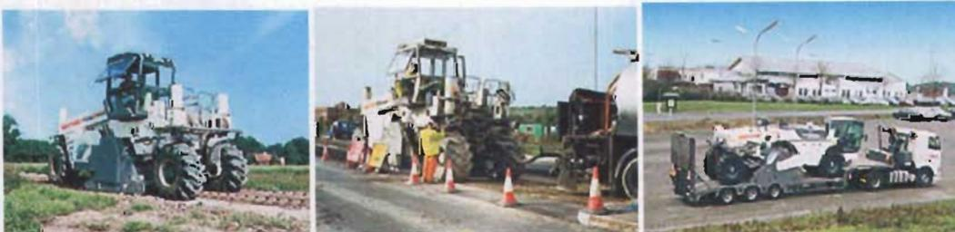
Fig 7.5 Equipos para el reciclado de pavimentos II (de izq a der. Wirtgen 2500S, 2500SK y eq. Kenworth-Goldhofer)
