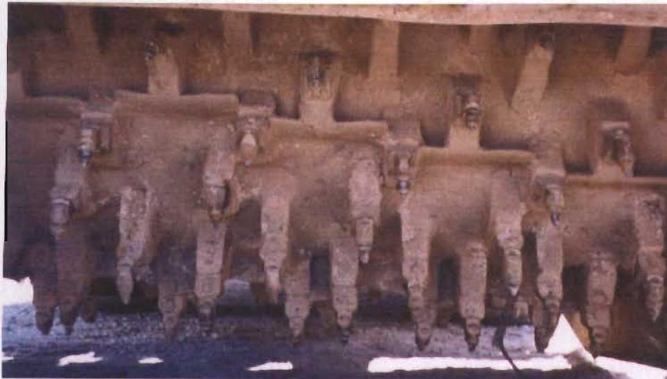
Fig 7.2 Rotor de recuperación para máxima fuerza de desprendimiento
