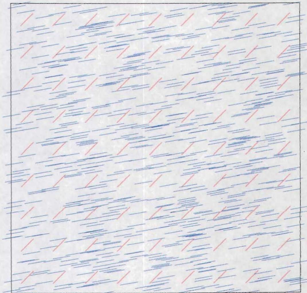
Figura 1. Configuración inicial con agujas con orden orientacional correspondiente a una densidad igual a 3. Con  $N = 800$  agujas rectas totales en la caja de simulación en color azul y  $n = 81$  agujas con centros de masa en una posición y orientación fija en color rojo.
