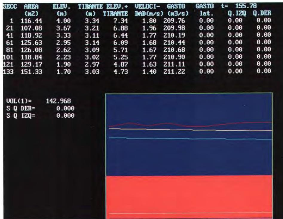
Figura 6.15. Cálculo del perfil del flujo para un t =155.78 h.
