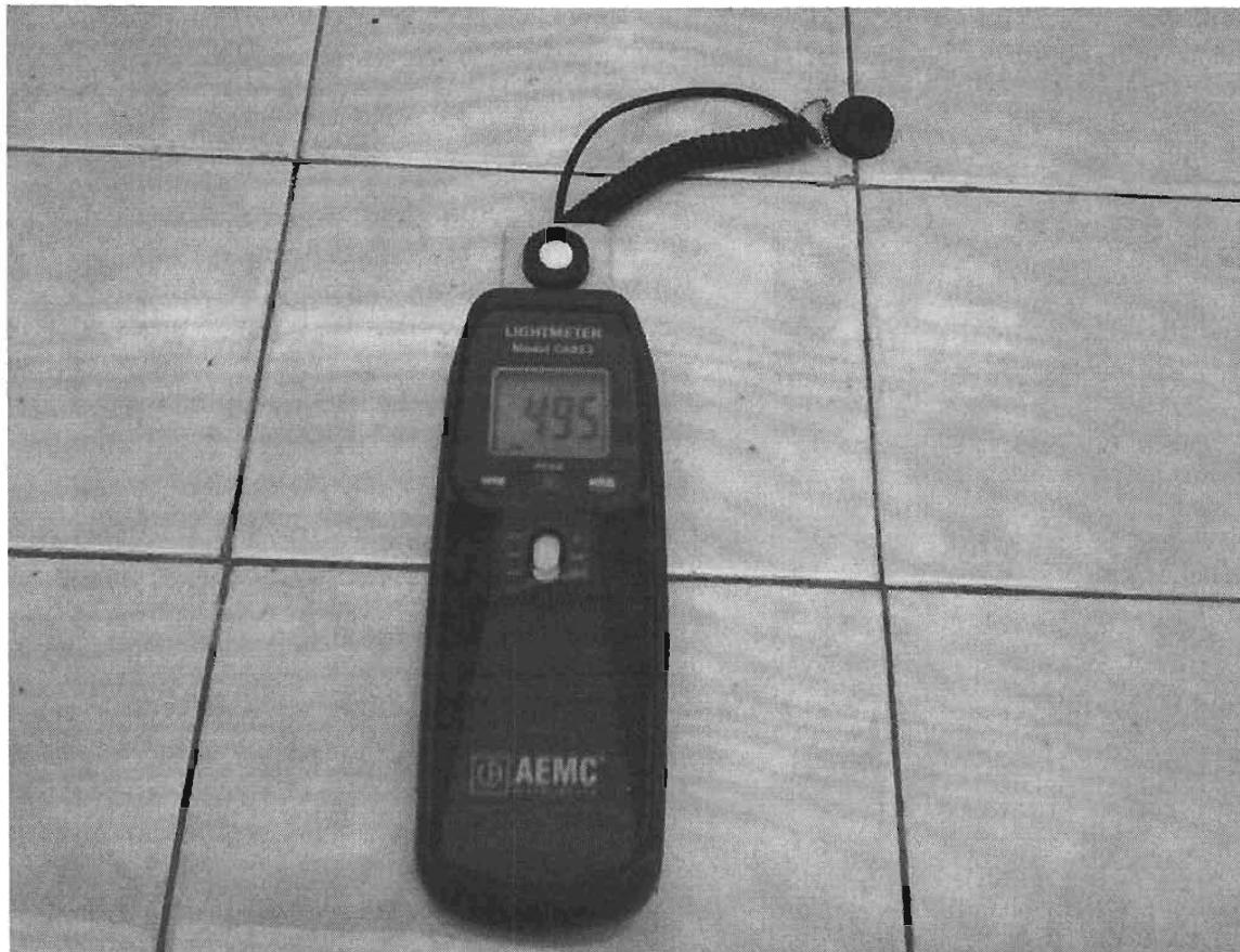
Figura 1.5.6. Luxómetro - LIGHTMETER modelo CA813 con capacidad de 200 klux, marca AEMC.
