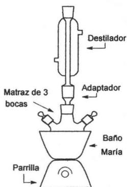
Figura 3.3 Dispositivo para realizar la segunda parte del proceso de la síntesis del TAAB
