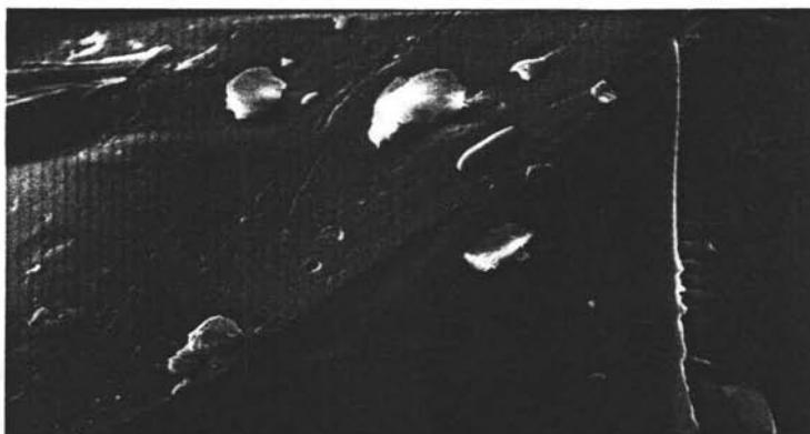
Figura 4.35 Material obtenido en la reacción Rx4 a 2000 aumentos
