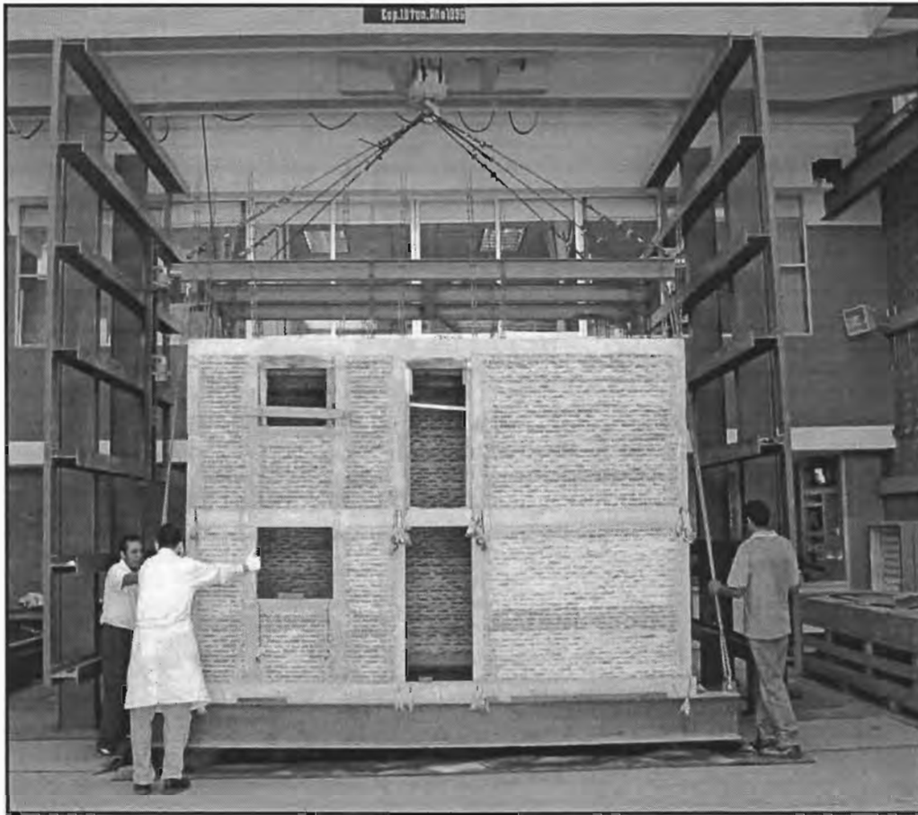
Fig 3.14 - Transporte del modelo hacia la mesa vibradora
