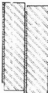
Fig 2.13 Capacitor con dieléctrico de papel
