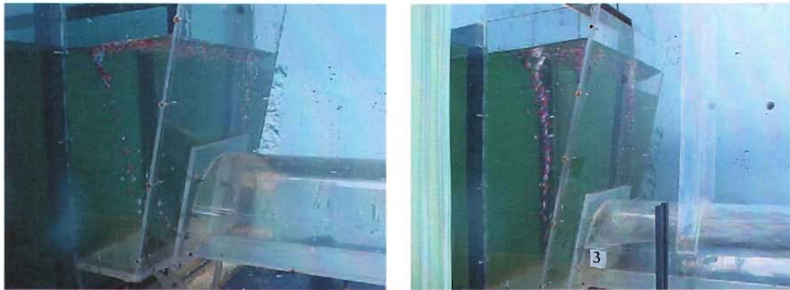
Vórtices que introducen aire al túnel.
