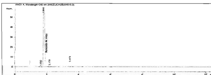
Figura 48. - Cromatograma de Solución de Benzoato de sodio con HCl 1N (15 días)
