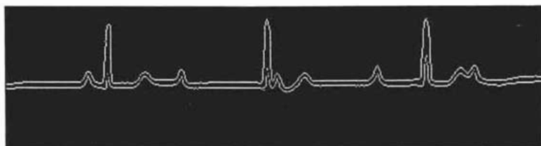
Figura 3.25. Imagen después de la aplicación del detector de bordes de Canny. Notar las discontinuidades que aparecen en la parte inferior del trazo.
