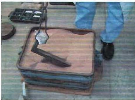
Foto 18 Desmoldeo de la pieza fabricada con la Aleación A-356 por el proceso de Lost Foam.
