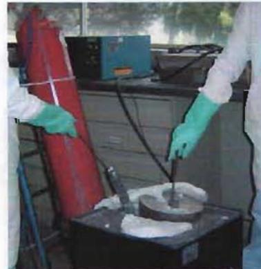
Foto 11 Desgasificación de la Aleación A-356 con gas Argón
