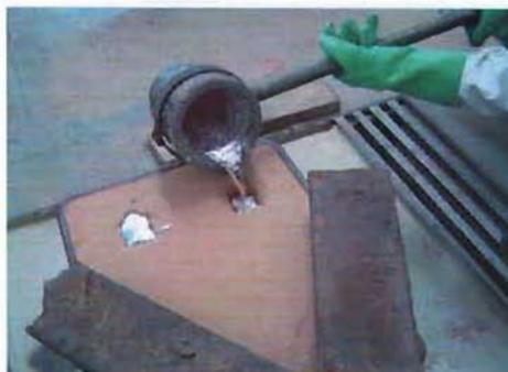
Foto 12 Llenado del molde de arena en verde con la Aleación A-356.
