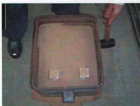
Foto 9 Compactado de la Arena Sílica mediante vibración
