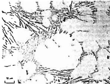
Nivel 2 Estructura Laminar, con bajos niveles de Sr. Con remanentes de Si acicular.
