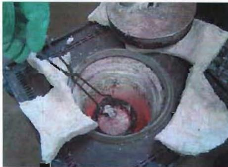
Foto 10 Fusión de la Aleación A-356 en horno de resistencias
