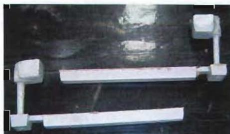
Foto 14 Pieza fabricada con la Aleación A-356 por el proceso de moldeo en verde.
