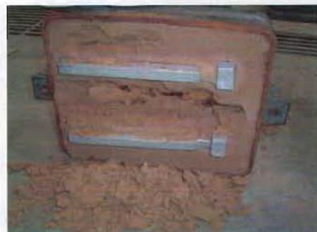
Foto 13 Desmoldeo de la pieza fabricada con la Aleación A-356 por el proceso de moldeo en verde.
