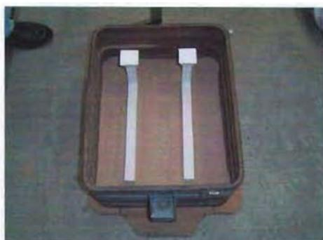
Foto 6 Colocación del modelo de Poliestireno en la caja de moldeo
