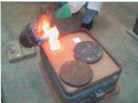
Foto 17a Llenado del molde de Poliestireno con la Aleación A-356.
