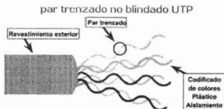
Fig. 2.9 Estructura interna del par trenzado no blindado (UTP).
