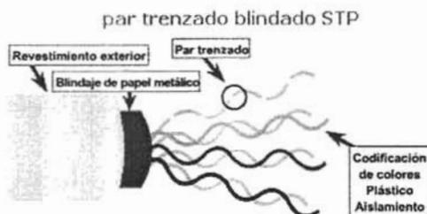
Fig. 2.8 Estructura interna del par trenzado blindado (STP).
