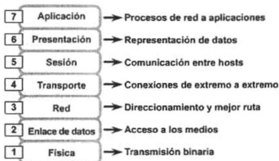
Fig. 2.23 Funciones de las capas del Modelo OSI.
