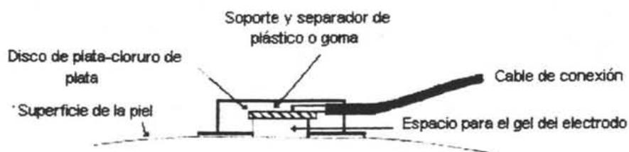
**Figura 4.9. Diagrama de electrodo superficial del tipo flotante.**
