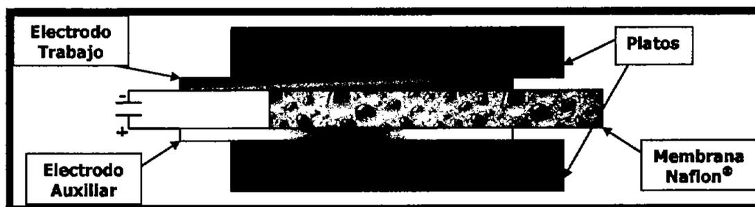
Figura 15: Celda electroquímica de electrolito sólido, para la realización de la electropolimerización in situ de tiofeno en la membrana Nafion<sup>®</sup>
