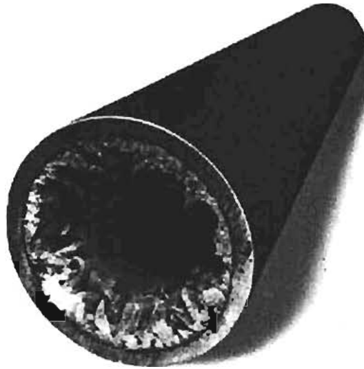
^Figura 4.15 Los efectos de las incrustaciones pueden resultar dramáticos e inmediatos: un ejemplo es el campo Millar en el Mar del Norte, los Ingenieros se sorprendieron al ver descender la producción de 30,000 BPD a cero en el lapso de 24 horas.
