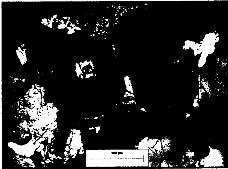
Foto 4.6. Fotografía tomada con nicols cruzados. Objetivo 2.5X. Se puede observar en la parte central de la imagen cristales de plagioclasa zoneada con maclas polisintéticas y alteración a minerales arcillosos.
