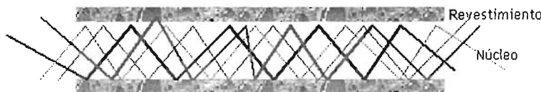
Figura 2.8 Fibra óptica multimodo.
