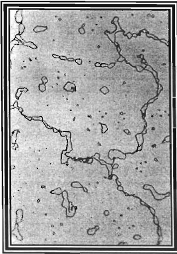
Metalografía de probeta a 550°C, 5 horas
