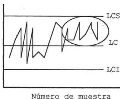
**Figura 9.2.4.2.** Desplazamiento en el promedio del proceso.
