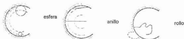
Figura 3.10 Exclusión de tamaños en un poro circular para esferas duras, anillos rígidos y rollos de cadenas aleatorias, se muestran las zonas de exclusión del centro de la esfera y del anillo, además se muestra la conformación permitida (—) y prohibida (——) de un rollo de cadena aleatoria.
