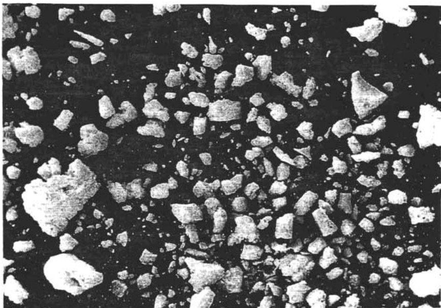
Imagen 17: MBE de partículas de BaSO 4 , 45X, las partículas tienen un tamaño entre 185 \mu\text{m} y 3 \mu\text{m} .
