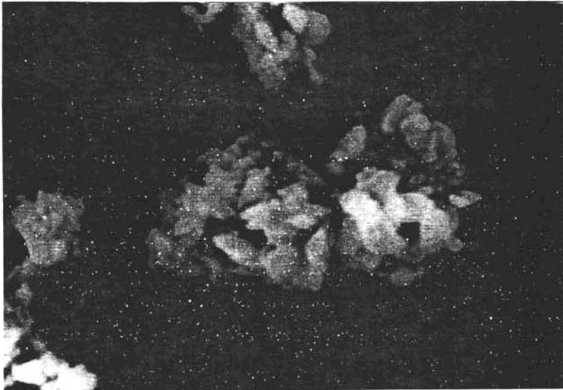
Imagen 32: MBE de partículas de \text{BaSO}_4 , 4500 X
