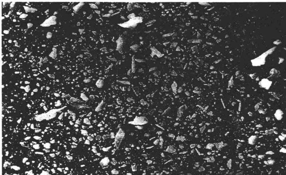
Imagen 4: MBE de partículas de \text{BaSO}_4 , 45X, preparadas con ayuda de una amina primaria, p - toluidina, con un mezclado lento y con agitación, las partículas tienen un tamaño entre 95 \mu\text{m} y 235 nm .
