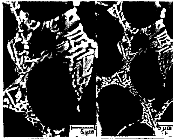
FIGURA 14- Microestructura de la aleación Al-7Si con 0.01 % Sr y agitada a 1050 RPM.
