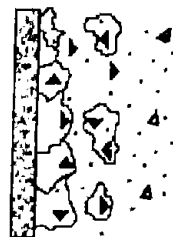
Crecimiento de \alpha(Al) y rechazo-atrapamiento del SiCp
