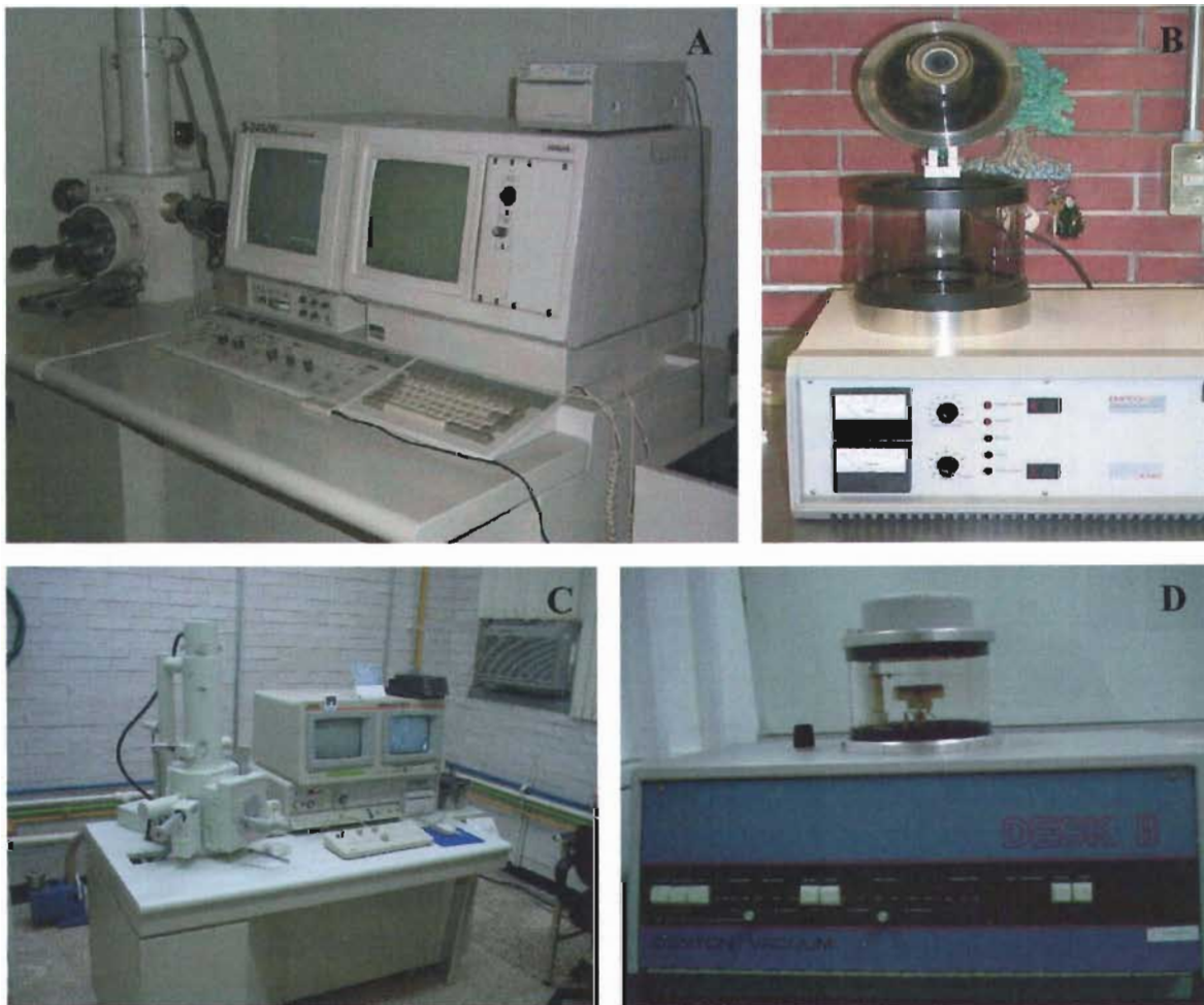
Figura 2. Microscopios electrónicos y ionizadoras utilizados en la preparación y observación del material. A. Microscopio Hitachi S-2460N. B. Ionizadora Emitech K550. C. Microscopio Jeol JSM-5310 LV. D. Ionizadora Denton Vacuum de vacío DC II. Fotografías cedidas por Berenit Mendoza y Silvia Espinosa.
