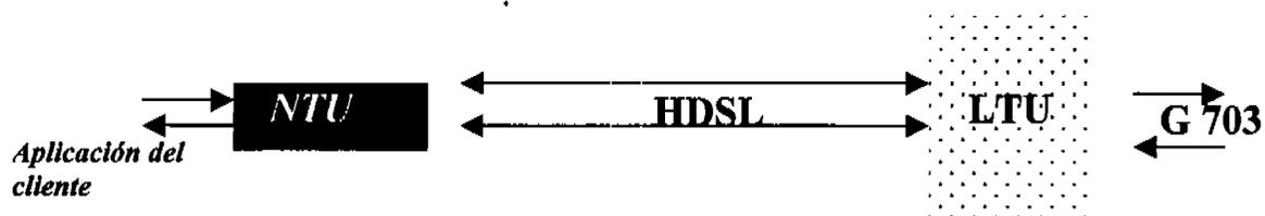
La Figura 4.1 Representación de un enlace HDSL de NTU a LTU
