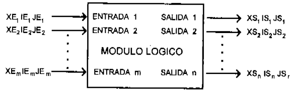
Figura 1.6.- Representación de un módulo lógico de m entradas y n salidas
