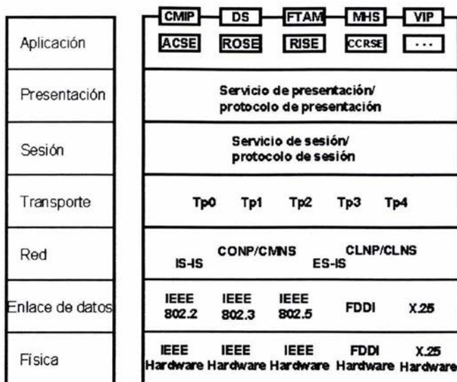
Figura 3.11 Grupo de protocolos de OSI, en relación al modelo de referencia OSI.
