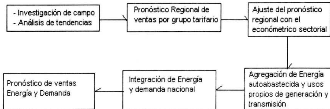
FIG. 1.13 Procedimiento para realizar estudios de mercado llevado a cabo por CFE en cada región del país en función de la demanda de energía
