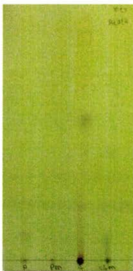
Figura 9. Placa de cromatografía en capa fina de los extractos de acetato de etilo de P. americana var. mexicana . De izquierda a derecha: pulpa inmadura, pulpa madura, semilla inmadura, y cáscara de semilla madura. Mezcla de elución: hexano:acetato de etilo (7:3). Revelador: cloruro de hierro (III) al 2% en alcohol.
