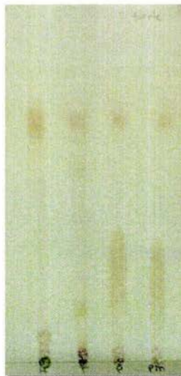
Figura 11. Placa de cromatografía en capa fina de los extractos hexánicos de P. americana var. fuerte . De izquierda a derecha: hojas, tallos, pulpa inmadura y pulpa madura. Mezcla de elución: hexano 100%. Revelador: sulfato de cerio (IV) y amonio en ácido sulfúrico.
