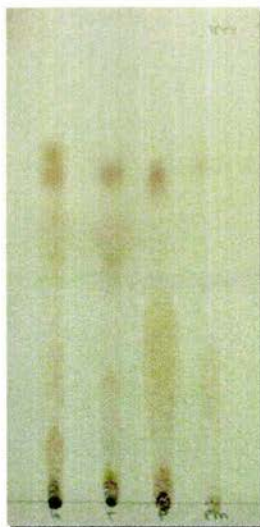
Figura 5. Placa de cromatografía en capa fina de los extractos hexánicos de P. americana var. mexicana . De izquierda a derecha: hojas, tallos, pulpa inmadura y pulpa madura. Mezcla de elución: hexano 100%. Revelador: sulfato de cerio (IV) y amonio en ácido sulfúrico.
