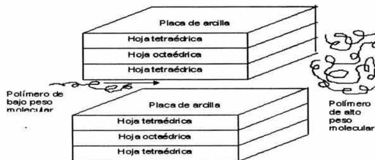
Figura 3.15 Representación esquemática del mecanismo de inhibición con polímeros de bajo y alto peso molecular.
