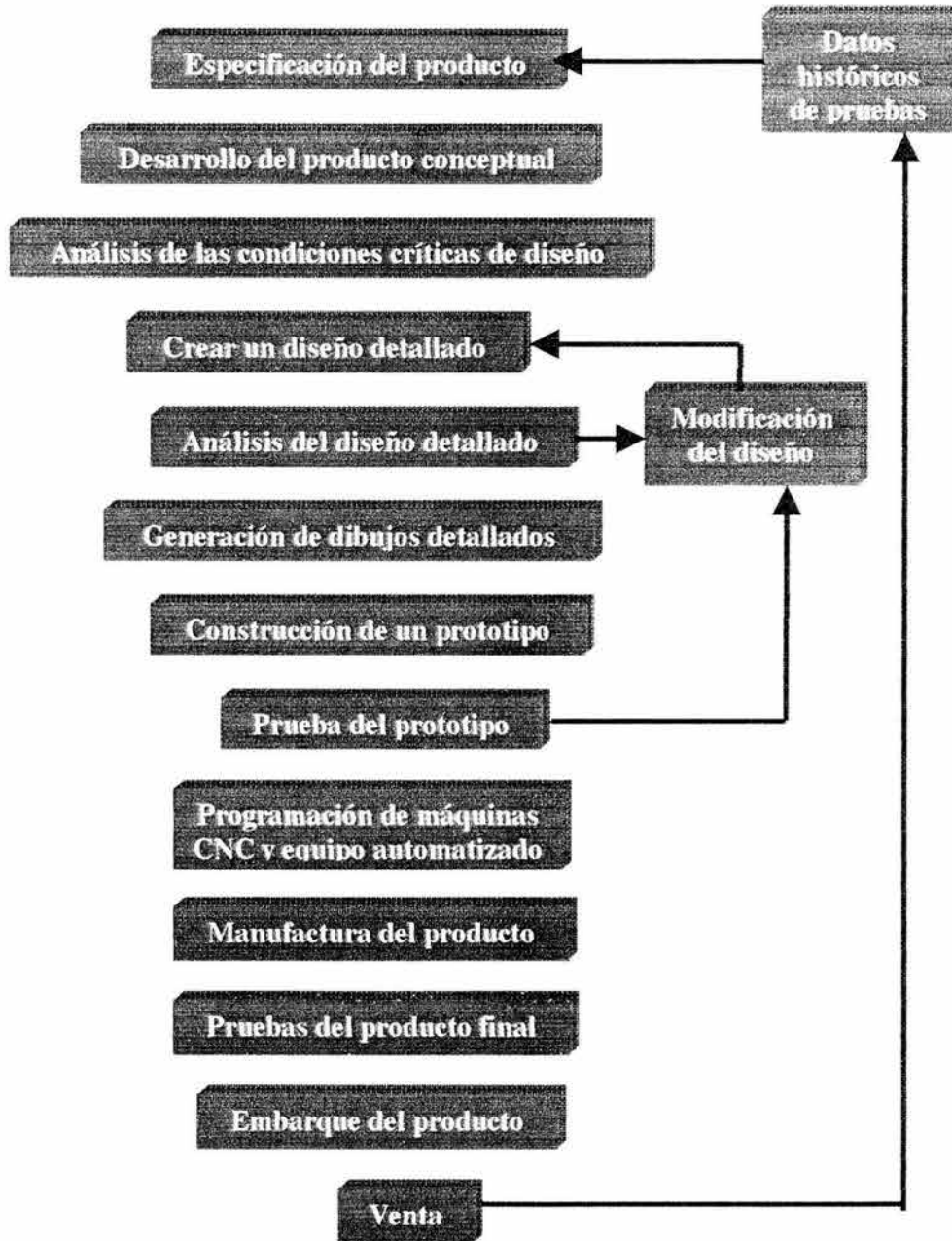
Fig. 3.2. Etapas en el diseño de un nuevo producto
