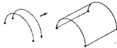
Fig. 3.6. Formación de una superficie curvada por barrido
