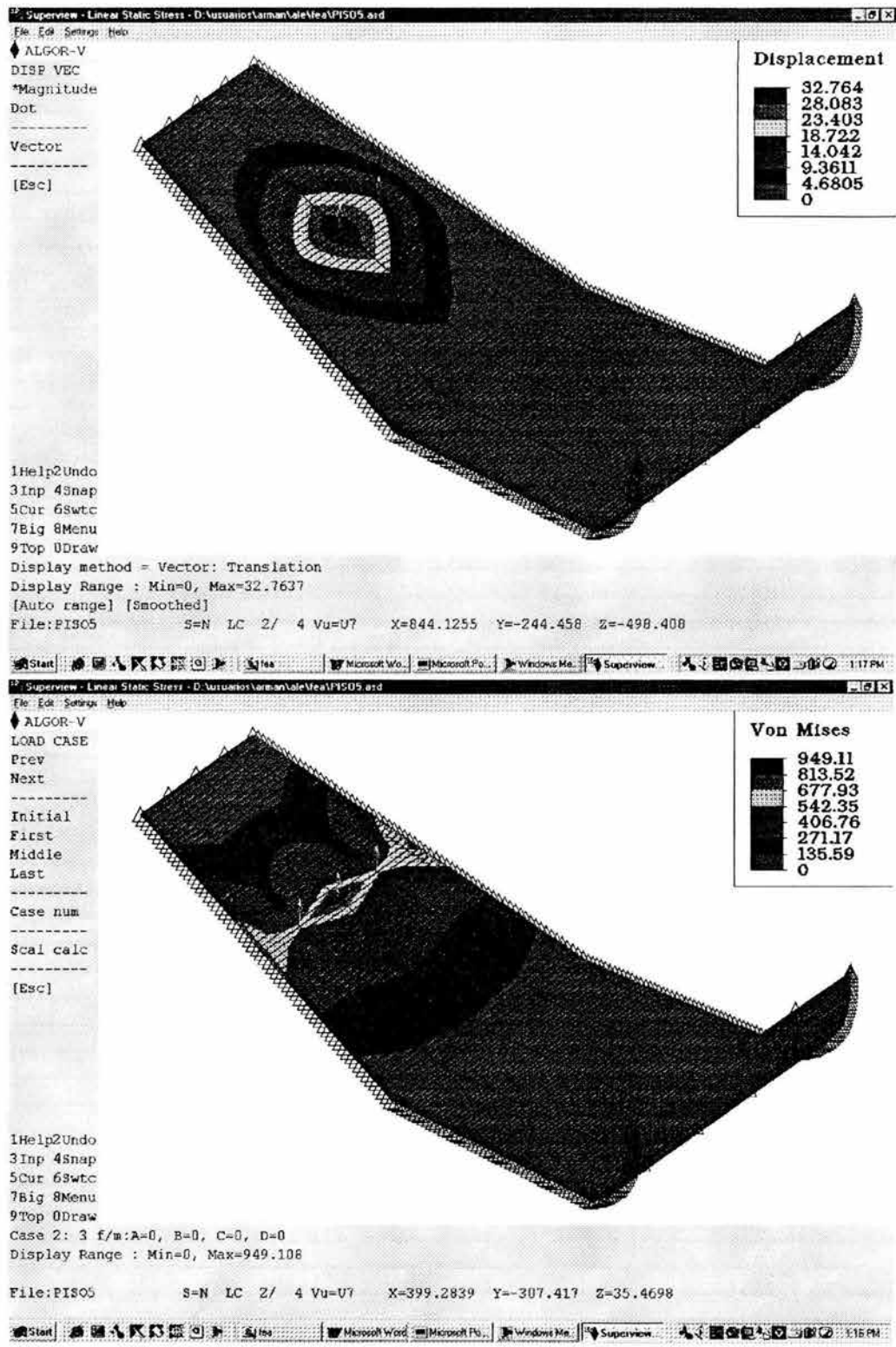
Fig. 5.26. Representación en código de barras de colores del desplazamiento (arriba), y del esfuerzo de acuerdo al criterio de Von Mises (abajo)
