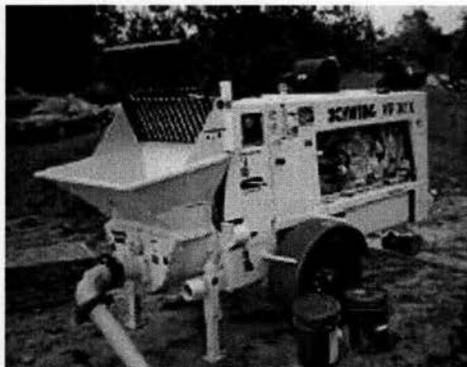
Fig. 4.4.1 Equipo de bombeo para el concreto lanzado
