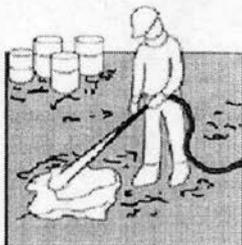
Fig. 3.2.19 Lavado con soluciones alcalinas
