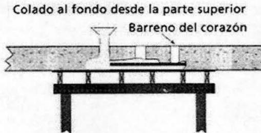
Figura 4.7.1. No se requiere equipo de bombeo para esta reparación elevada. Esta técnica se emplea con frecuencia para reparar losas, entresijos de estacionamientos y otras losas elevadas.
