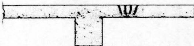
Fig. 2.3.15 Fisuras de flexión en voladizo
